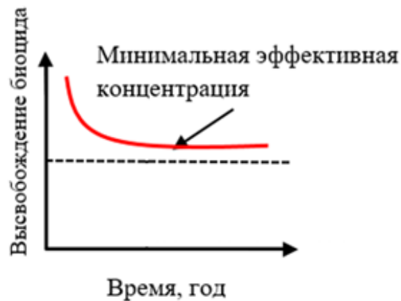
Рисунок 1.7 - Зависимость срока службы от скорости выщелачивания биоцида из самополирующихся покрытий
